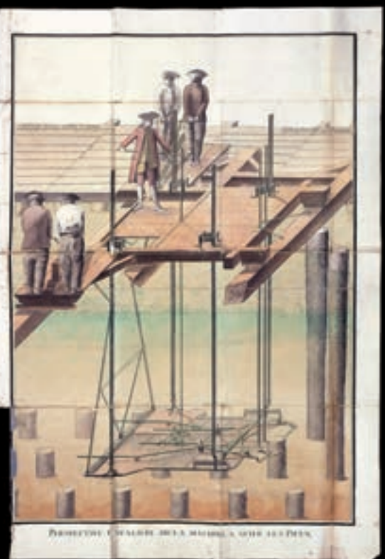
Perspective cavalière de la machine à scier les pieux.
